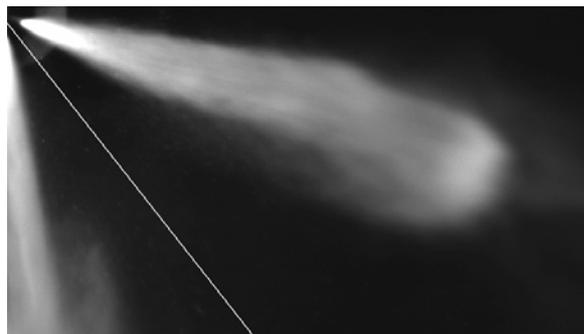
Рис. 2. Экспериментальный кадр процесса распыления топлива, выполненный со временем экспозиции 39 мкс, время задержки синхроимпульса от датчика давления – 300 мкс
