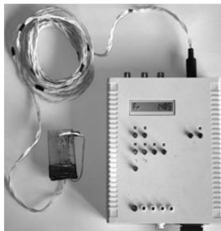
Рис. 3. Внешний вид блока управления синхронизацией с датчиком давления
